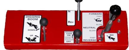
**CONTROLES**: Sencillo panel de mandos con todas las funciones controladas hidráulicamente. Ajuste fino de la velocidad de zanjeo para conseguir el mayor rendimiento.
