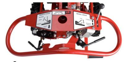
**DISEÑO:** Transmisión automática a las ruedas. Ajusta la velocidad a la carga de la cadena. Reduce el desgaste en motor y componentes.
